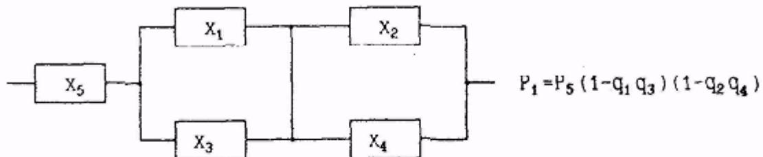
Теперь будем считать, что элемент  $x_5$  отказал, тогда в исходной схеме этот элемент можно заменить обрывом, а последовательно с получившейся схемой включить элемент  $x_5$ , но вероятность образования этой схемы равна вероятности неработоспособного состояния элемента  $x_5$ .
