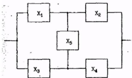
Выберем в качестве особого элемента элемент  $X_5$ , как имеющий наибольшее число связей с другими. Предположим, что элемент  $X_5$  находится в работоспособном состоянии, тогда вместо элемента  $X_5$  в
